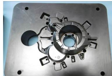
Werkstoff: 1.2343 ESU, Aluminiumdruckguss
