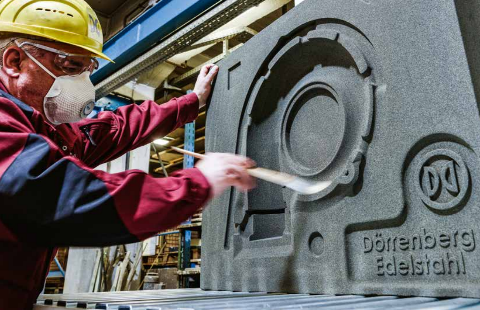
Gedruckte Sandform wird vom überschüssigen Sand gereinigt
