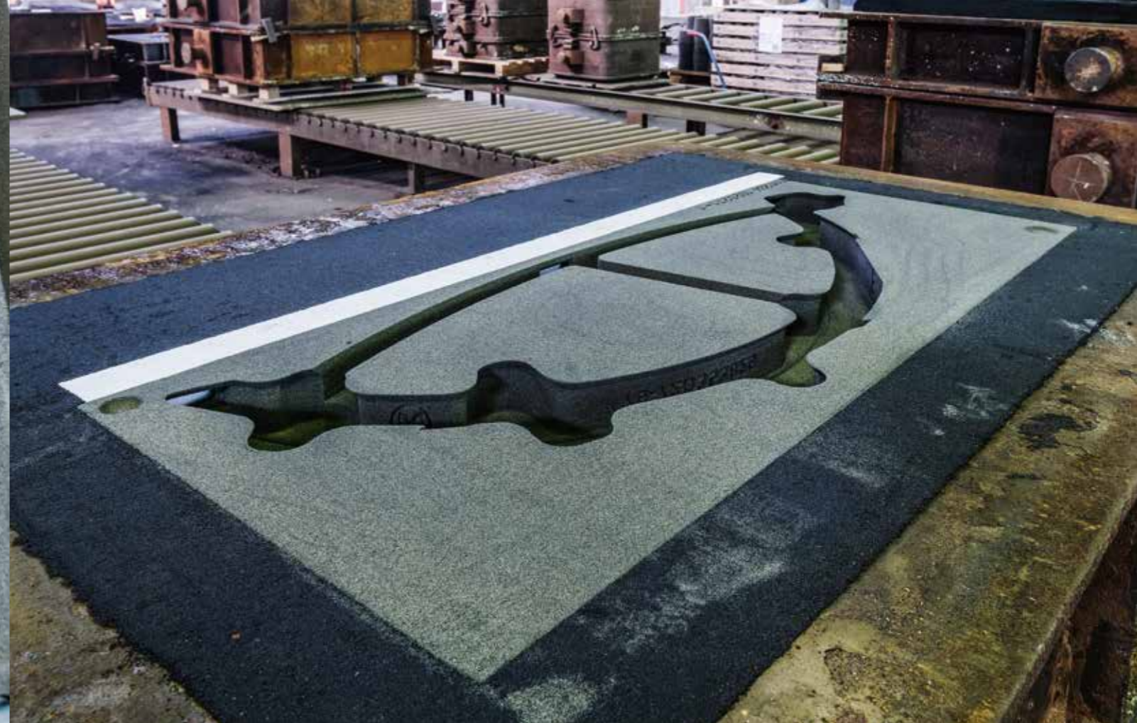
Geteilt gedruckte Sandformen werden im Formsand eingebettet
