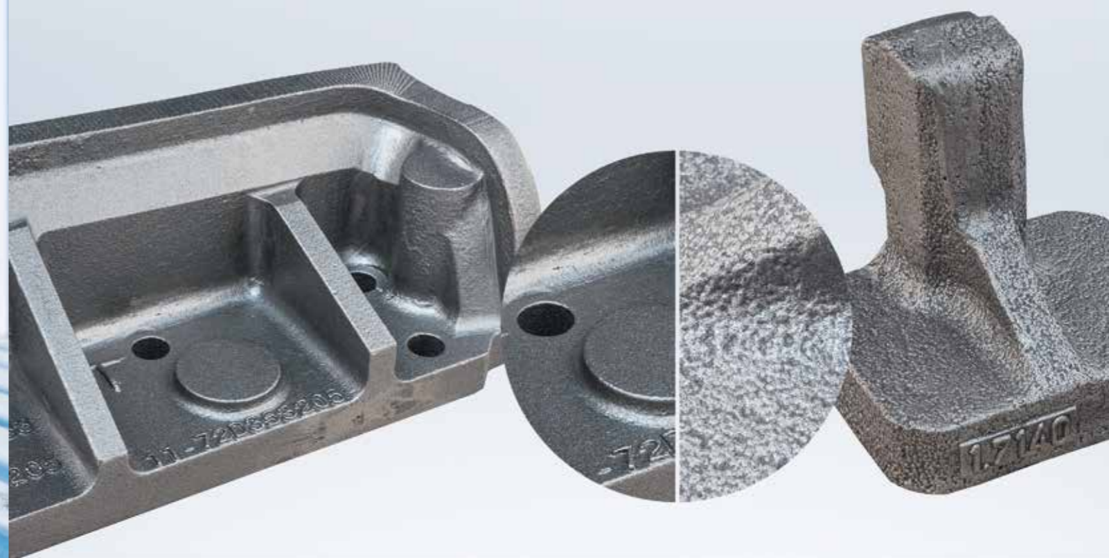
Deutlich sieht man den Unterschied der Oberflächen bei Messern, die nach dem Vollformgussverfahren bzw. mit geprinteten Formen hergestellt wurden
